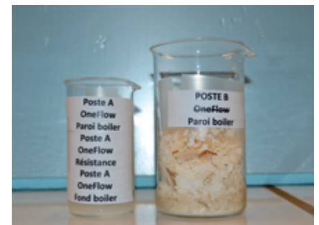
Vergelijking van de hoeveelheid kalk op de wand, de weerstand en de bodem van de boiler (links met een waterverzachter met korrels, rechts zonder waterverzachter).
