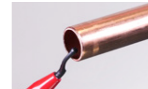
3. Gebruik een potloodtype ontbramer voor de binnenranden
