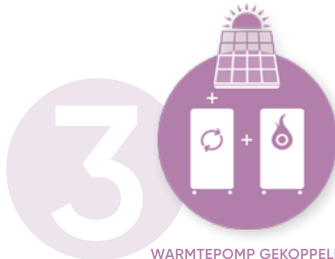
WARMTEPOMP GEKOPPELD AAN PV-PANELEN + BIJVERWARMING VIA KETEL (VERSIE MET WARMTEWISSELAAR)*
